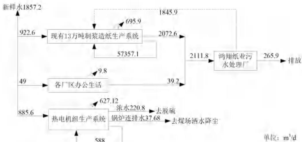
图 3.4-8 现有工程清洁生产节水改造后全厂水平衡图
